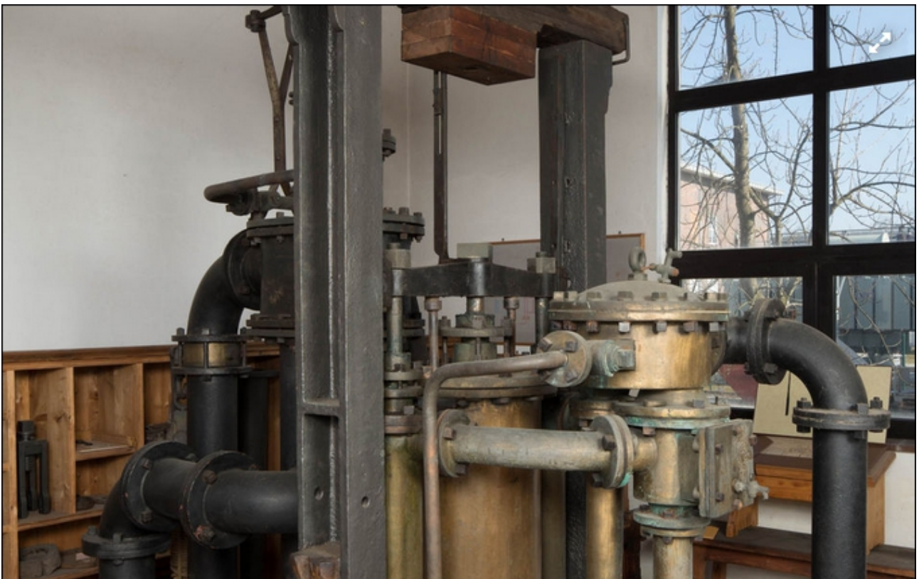
Das ist die Reichenbach sche Solehebe-Wassersäulenmaschine von ~ 1810
